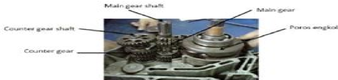
Komponen dalam rumah transmisi
